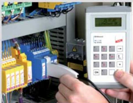
在本质安全电路 (蓝色), 通过RFID技术 (LifeCheck) 测试一个SPD模块
