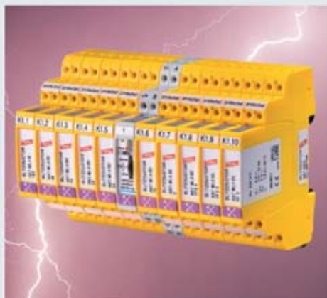
内置LifeCheck的监测电路的状态监控装置，导轨安装，尺寸小节省空间且接线少，并能监测最多10个BXT模块。当预期SPD将过载时，故障信号可视，同时通信触点动作。
